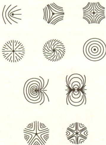
Rys. 8. Różne typy dysklinacji (rzut z góry). Ciągłe linie oznaczają kierunek uporządkowania orientacyjnego (rys. 2a, 2b) cząsteczek, a czarne punkty reprezentują linię dysklinacji. Są to typowe defekty występujące w ciekłych kryształach, łatwo widoczne pod mikroskopem.
