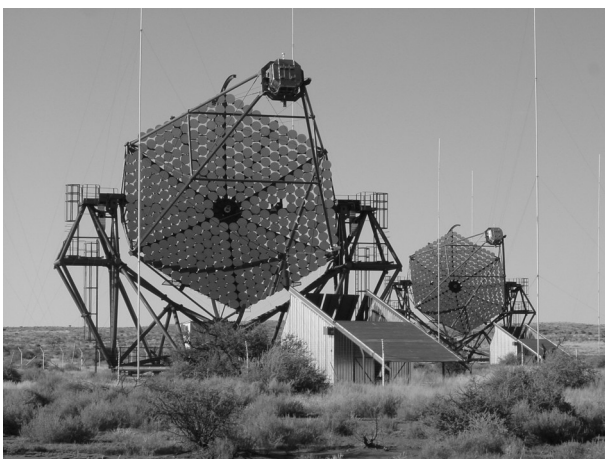
Rys. 2. Dwa z czterech teleskopów systemu HESS. Widoczne są wielosegmentowe lustra oraz znajdujące się w ognisku zwierciadeł detektory. Gdy teleskop nie prowadzi obserwacji, detektory chowane są do małych schronów widocznych w dole zdjęcia. Stojące w pobliżu teleskopów maszty to instalacja odgromowa.
