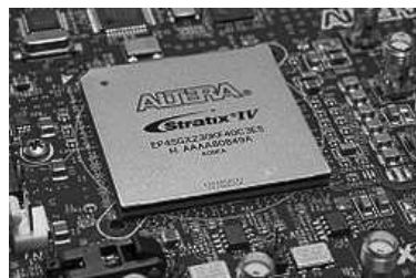
Układ programowalny Altera Stratix IV GX FPGA realizujący model obliczeń oparty o obwody logiczne
