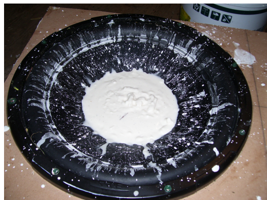
Przykład cieczy nienewtonowskiej wykonanej domowym sposobem – mieszanina skrobi kukurydzianej i wody umieszczona na membranie głośnika. Ciecz pod wpływem drgań przyjmuje dynamiczne, nieregularne kształty. Materiał udostępniony na licencji CC BY 3.0; autor: Daniel Christensen
