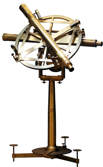
Rys. 1. Koło powtarzające Bordy przeznaczone do precyzyjnych pomiarów geodezyjnych, zbudowane dla ekspedycji w pracowni Etienne'a Lenoira Źródło: Rama, CC BY-SA 3.0 FR via Wikimedia Commons
