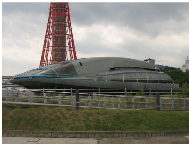
Rys. 2. Statek Yamato 1 – jedyna znana realizacja napędu MHD. Fot. Geofrog. Źródło: Wikimedia Commons, licencja CC BY-SA 2.5.
