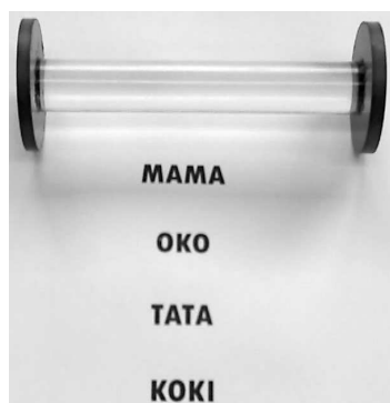
Fot. 1. Model magicznej soczewki w postaci szpulki, w której użyto kawałka szklanego pręta.
