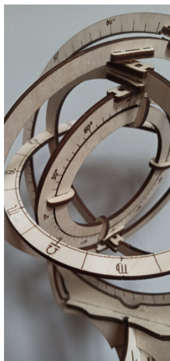
Rys. 5. Na czwartym kole przesunięto celownik tak, by wskazywał na Regulusa (aby można było dostrzec tę gwiazdę, patrząc przez dwa celowniki po przeciwnych stronach czwartego koła). Celownik wskazuje na czwartym kole szerokość ekliptyczną równą około 12°
