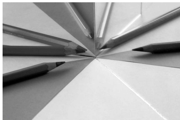
Fot. 1. Kąt między zwierciadłami jest równy \alpha = 135^\circ . Kredka leżąca w obszarze zacieniowanego klina ma dwa obrazy, kredka położona poza klinem – trzy.
